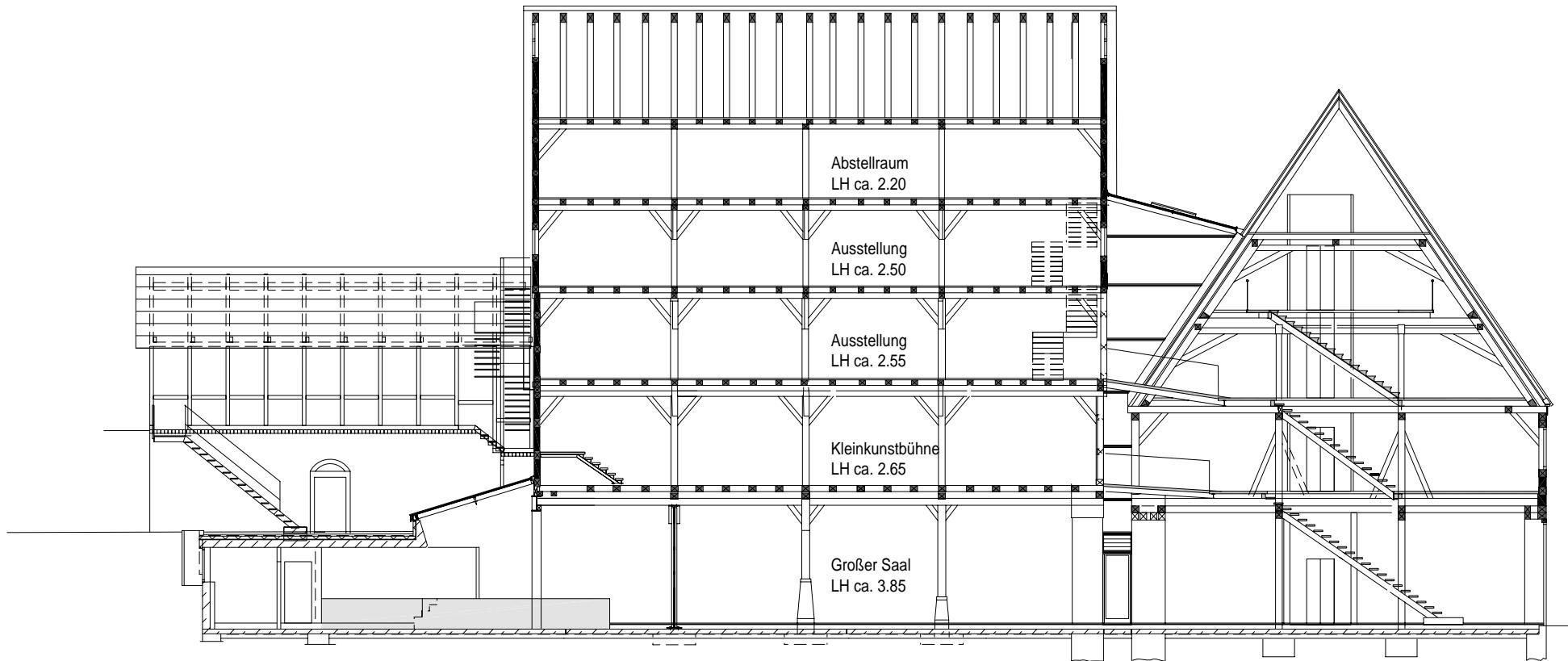
Bürgerhaus Zehntscheuer Münsingen - Längsschnitt Fruchtkasten / Querschnitt Zehntscheuer M 1:200
